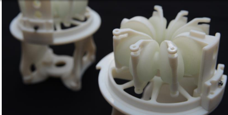
Bild: Der pneumatischer Festo Roboter Aktuator wurde in einem Schritt mit maximaler Funktionsintegration gedruckt © cirp
