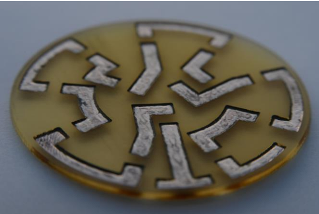
Bild: Das Philips LED-PCBA kombiniert leitfähige Tinte mit Polyimid © cirp
